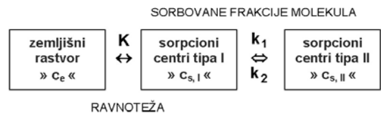
Slika 3. Šematski prikaz dvoprostorno neravnotežno/kinetičkog modela
